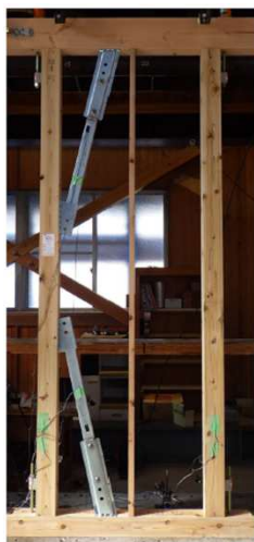
住友理工製 制震システム「TRCplus」
