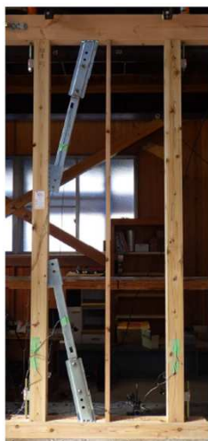
住友理工製 制震システム 「TRCplus」
