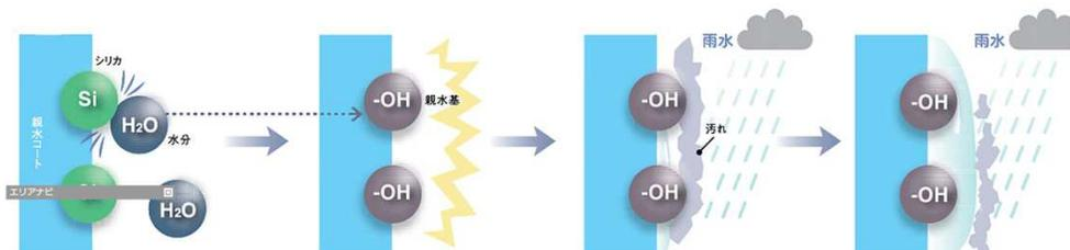
親水性の高いSi(シリカ)が空気中のH<sub>2</sub>O(水分子)を吸着します。
